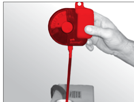
Fig. 98 Kontrol af frostbeskyttelsesblanding
