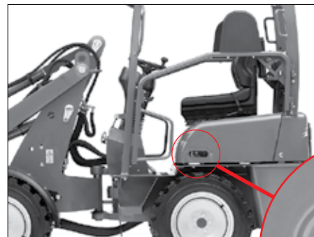
Fig. 80 Vipning af førerpladsen
